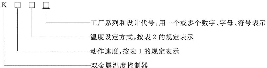
示例:KSD 301 表示突跳式双金属温度控制器,其动作温度是固定的、预先设定,型号代码为 301。
