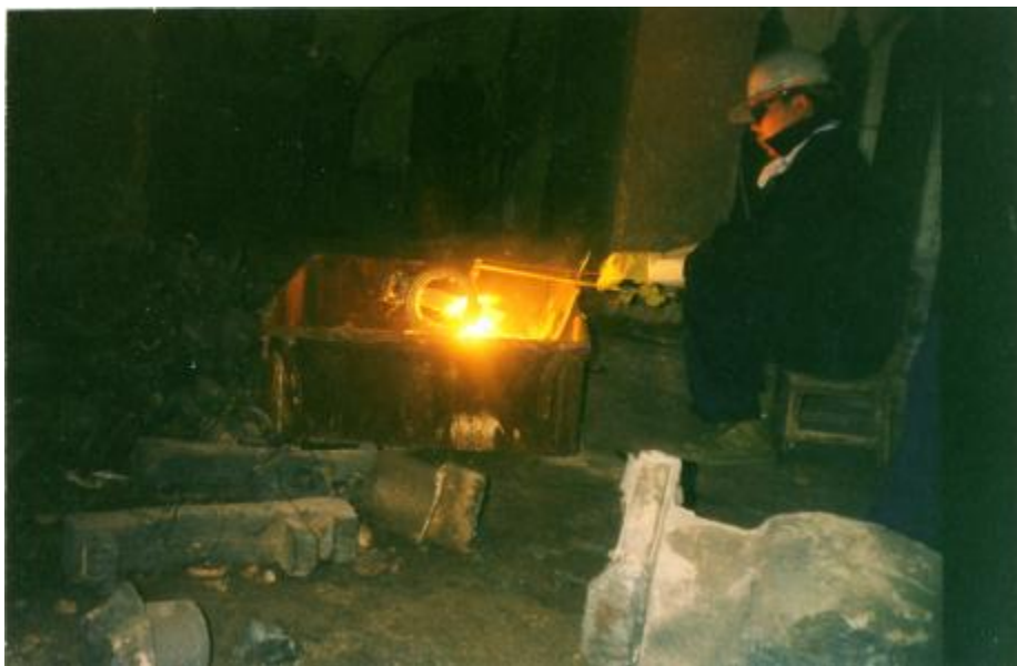
图 19 切割工人正在进行不锈钢冒口的振动切割
