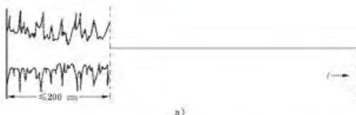
图3 定义为喀喇声(见3.2)的断续骚扰的例子
