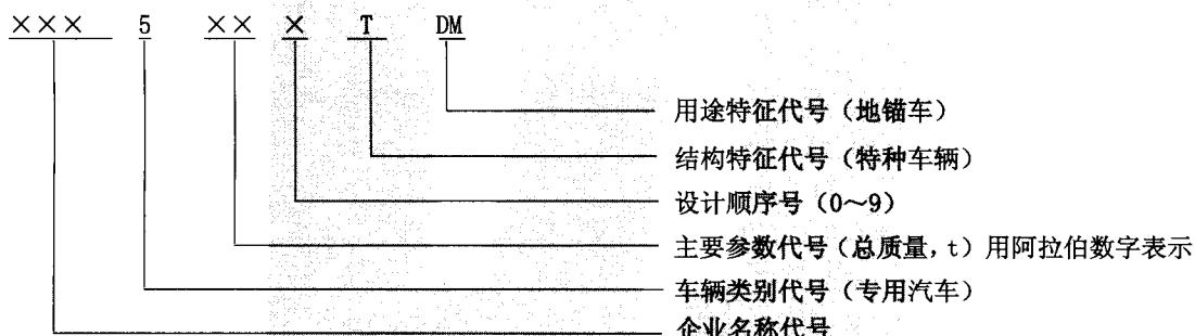
示例: 总质量 16t, 第一次设计, 某企业生产的地锚车, 型号表示为: ×××5160TDM。
