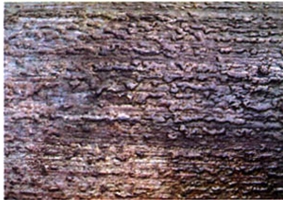
图 35 QSi3-1 1/2× 局部麻面(铸锭上面)
