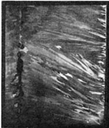
图 14 HMn58-2 1/4× 气孔型断续缩孔
