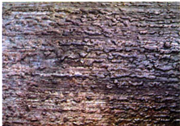
图 36 QSi3-1 1/2× 局部麻面(铸锭下面)
