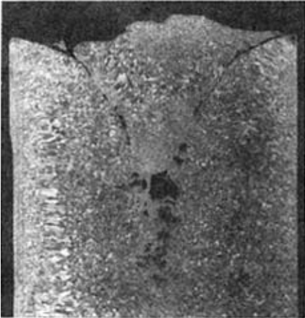
图 13 QSn6.5-0.1 1/2× 补缩不良引起缩松
