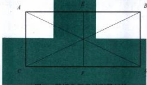
图 6 壁板几何尺寸测量部位
