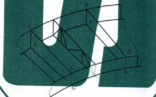
图 11 浮舱分段组对示意
