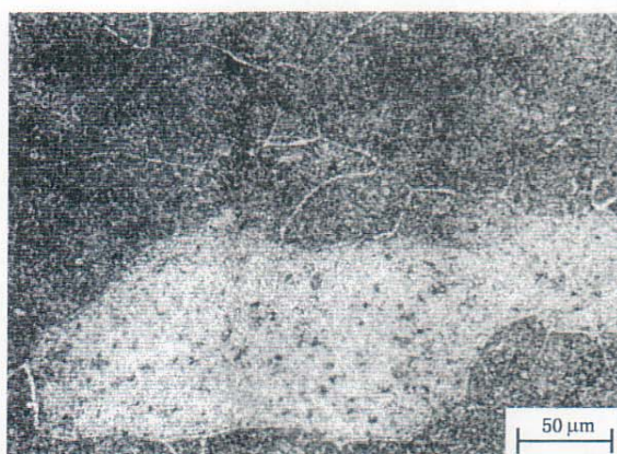
图 14 6063 合金型材风冷淬火正常组织(6 号浸蚀剂浸蚀)
