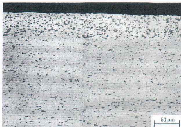
图 17 2Q515 合金包覆层组织(6 号浸蚀剂浸蚀)
