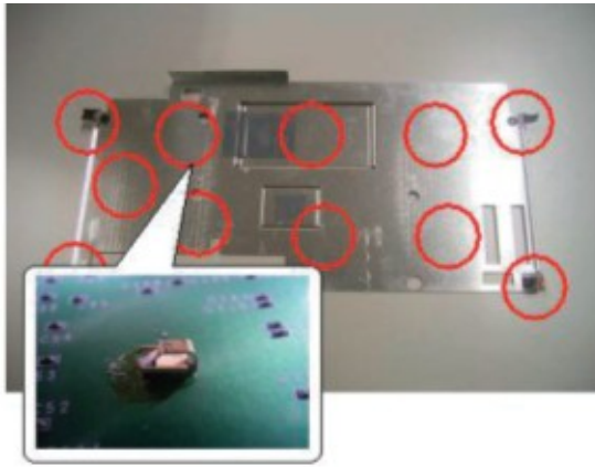
圖18 多點接地的部位與元件
