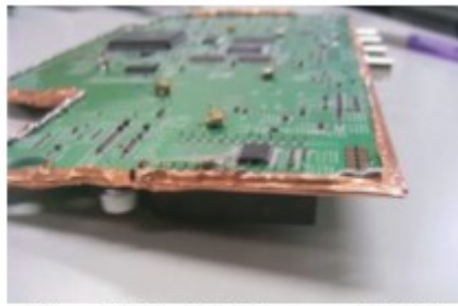
圖21 基板側面鋪設Shield的模樣
