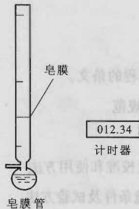
图1 皂膜流量计结构示意图
