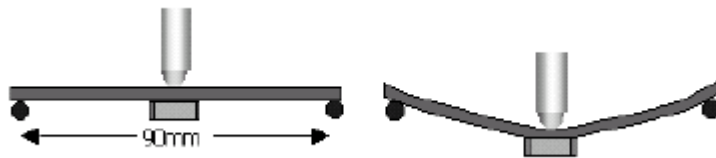
图3. 板子弯曲折曲由AEC-Q200测试认证
