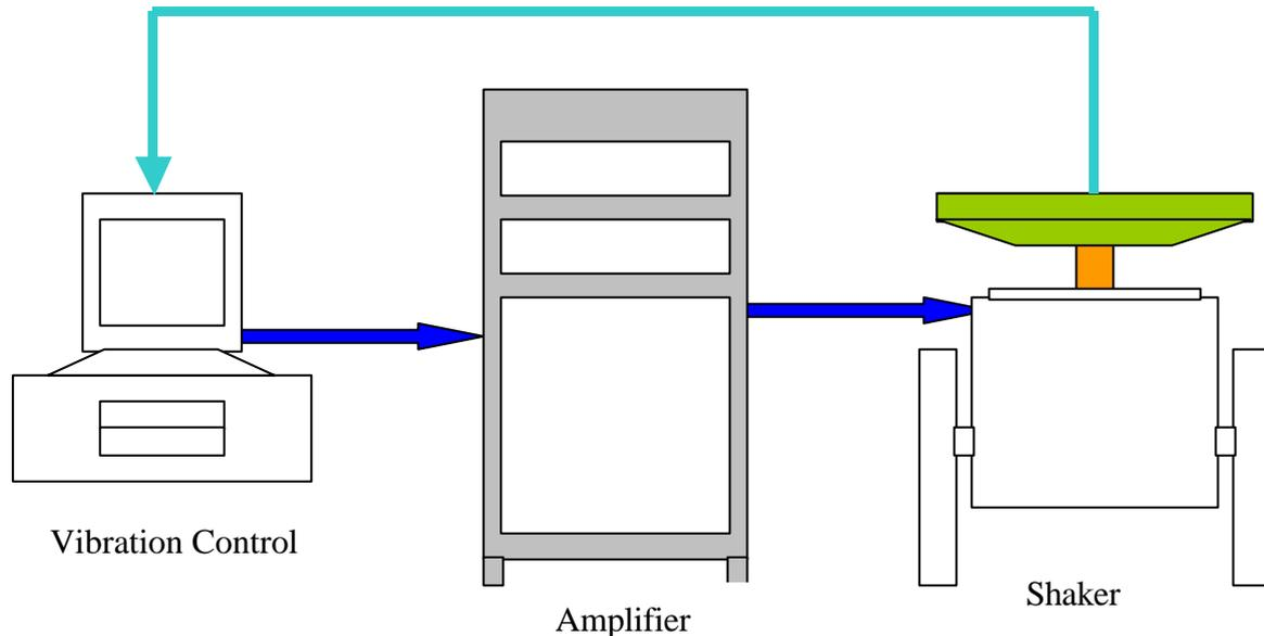
上圖就是一個簡單的振動試驗系統，其動作方式為：我們先在振動控制器（Vibration Control）輸入試驗條件，控制器就將訊號送到放大器(Amplifier)，放大器再將訊號放大去推動振動機(Shaker)，使振動機產生振動；控制器也會去偵測振動機的試驗條件，以便去增加或降低能量，使振動量在設定的規格內。
