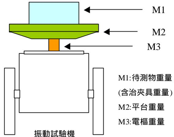
由計算所知振動試驗機需 778Kgf 的推力，若沒有考慮平台、電樞重量，那計算出來的推力僅 355Kgf，若使用此推力的試驗機當然不符合我們的需求。
