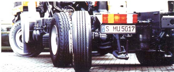
图4 第3桥为随动转向桥
