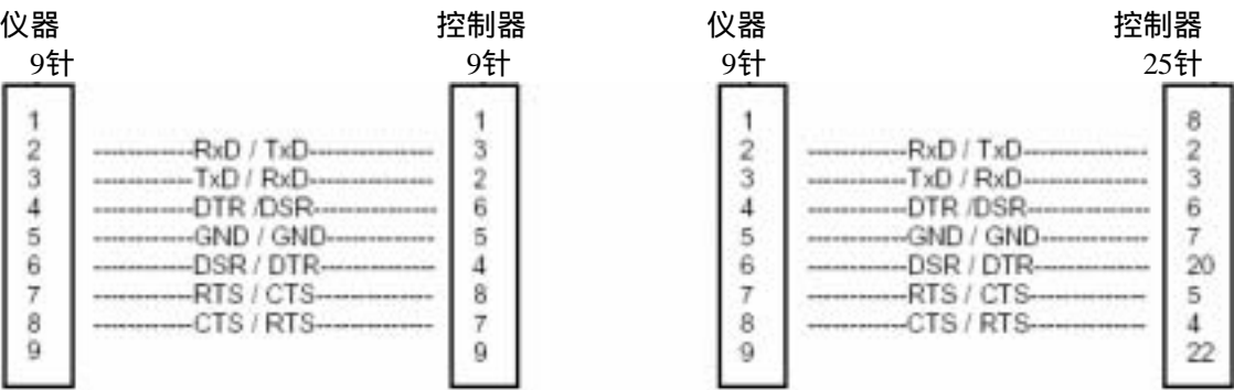
图 8-2 硬件握手的数据,控制和确认线的连线图
