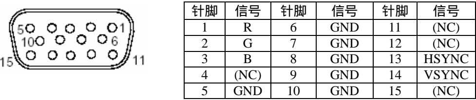
图 8-6 MONITOR接头的针脚分配.
