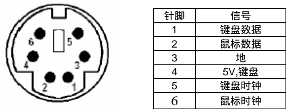
图 8-2 KEYBOARD插孔的针脚分配.
