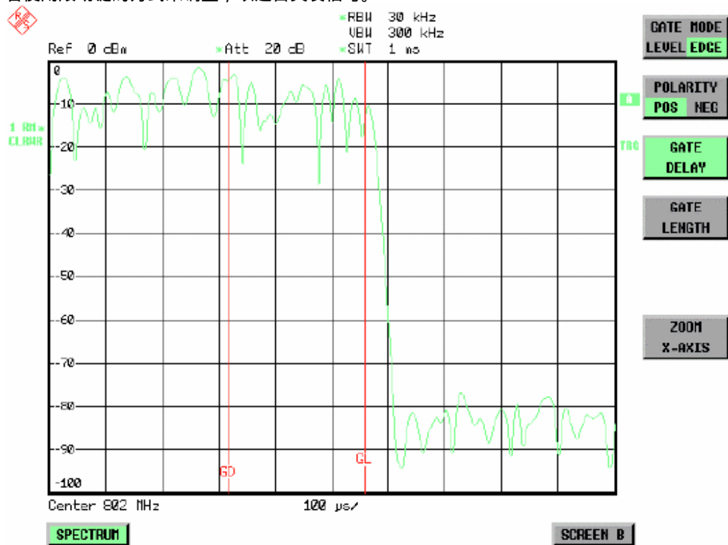
图.4-4 通过GD和GL线的方式在时域当中设置门延迟（GATE DELAY）和门长度（LENGHT）
