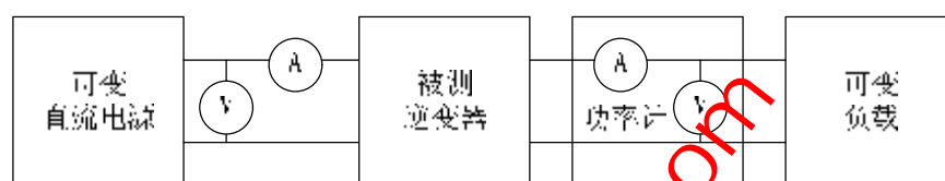
图 10 输出电压变化范围测试电路
