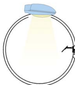
图 3：用积分球测量 LED 路灯的光通量
