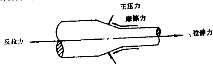
图 2-6 有反拉力的拉线时线材受力情况
