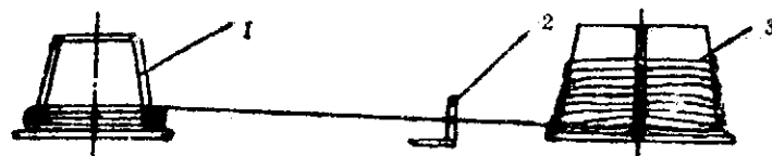
图 4-2 立式单模拉线机示意图
