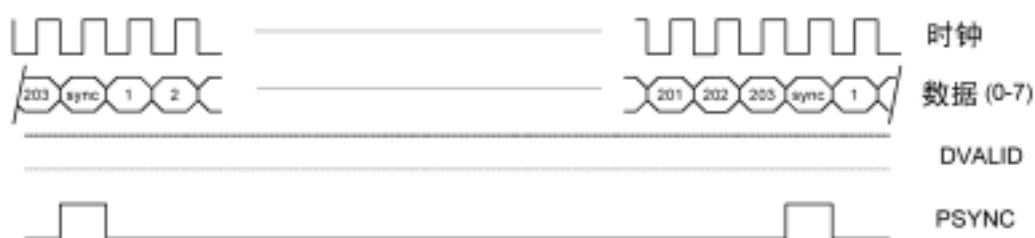
图 A5 204 字节包的传输格式（188 个数据字节及 16 个填充字节）
