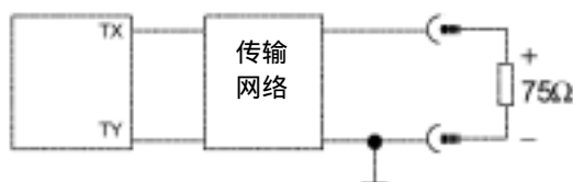
图 A19 同轴电缆发射器测量电路
