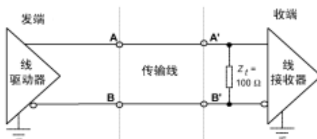
图 A8 线驱动器与线接收器的互连
