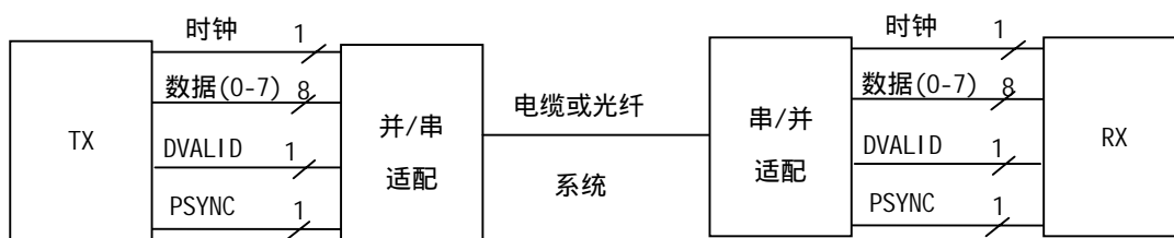
图 A24 适配模块的连接
