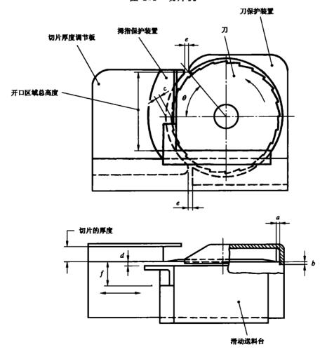
图 102 切片机的保护装置
